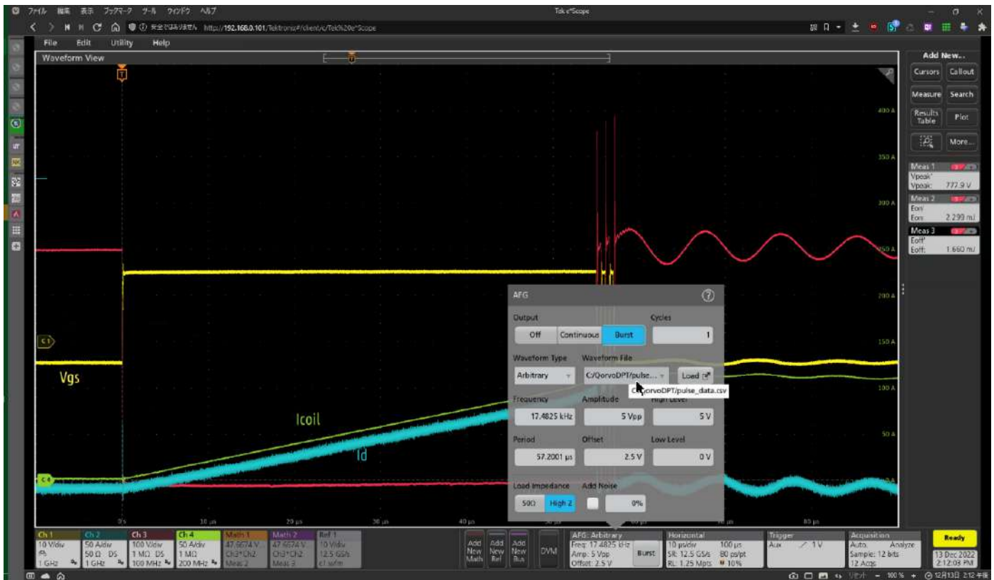
圖 14：程式執行後的 AFG 對話框顯示了程式配置的設定。
