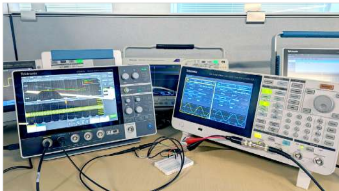
圖 8：使用 AFG31000 和 2 系列 MSO 產生波德圖。
