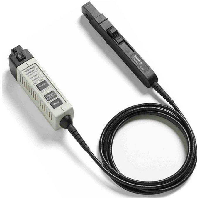
TCP0030A 是專為直接連接具 TekVPI™ 探棒介面之示波器並與其搭配而設計的高效能易用型交流/直流電流探棒。此交流/直流電流量測探棒提供 120 MHz 以上的頻寬，使用者亦可選擇 5 A 和 30 A 量測範圍。此外，TCP0030A 也具備出色的低電流量測功能（電流強度低達 1 mA）與準確度，能夠滿足現今電流量測的嚴苛需求。
