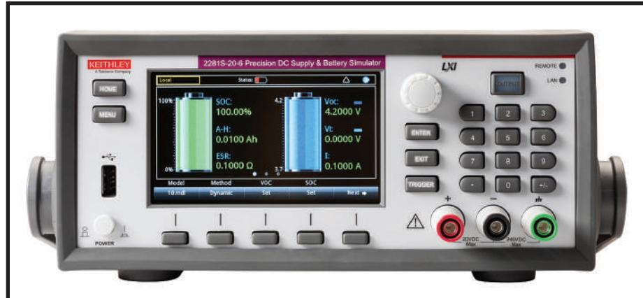
2281S 系列電池模擬器和精密直流電源供應器創新性地整合電池模擬與高精密電源供應器和電池測試的功能；同時也能分析待測裝置的直流消耗、測試電池，並根據電池充電程序產生電池模型，以及根據電池模型模擬電池。2281S-20-6 可以輸出高達 20V 和 6A 的電源，以及輸入高達 1A 的電流。
