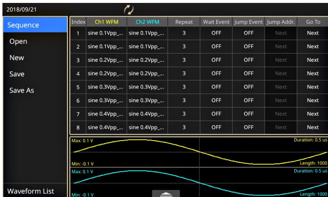
進階模式可讓您以靈活多變的步驟控制建立複雜波形順序
